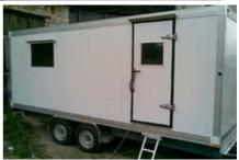
**Прицепы-модули специальные** (далее прицепы-модули) выполнены в изотермическом варианте из сэндвичпанелей толщиной до 60 мм, угловые элементы — анодированный алюминий. Две плотно-закрывающиеся двери — одна с окном с правой стороны прицепа, другая, глухая, одно- или двухстворчатая расположена в задней части прицепа. С левой и правой сторон прицепа - сплошные окна из двойных стеклопакетов, размер окна - не менее 600х800 мм.
